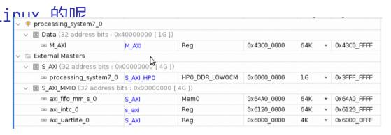
注意这里的 M\_AXI 地址: 0x43C0\_0000。用户态程序通过打开 /dev/mem 访问物理地址 0x43C0\_0000,在 AXI 总线上,这 个地址会对应到 Rocket Chip 端的 0x0000\_0000 地址。
