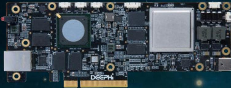
视频结构化服务器加速卡
